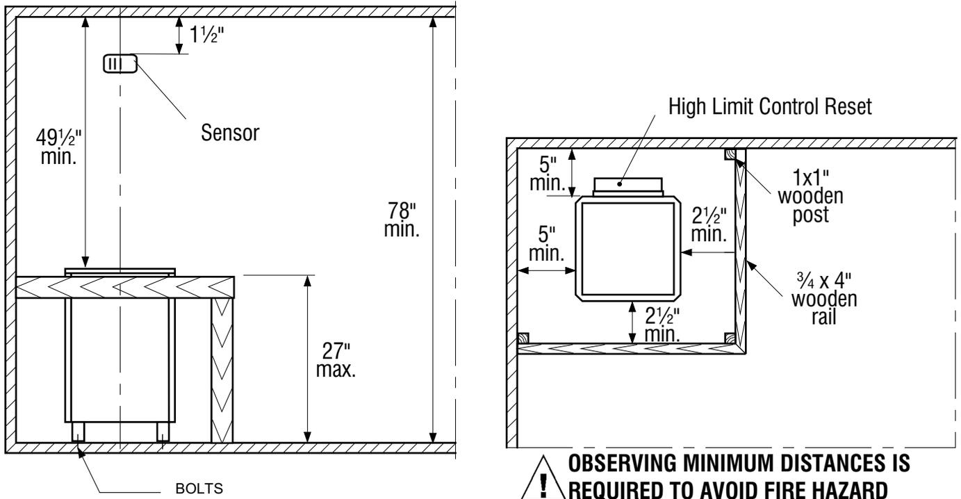
**! OBSERVING MINIMUM DISTANCES IS REQUIRED TO AVOID FIRE HAZARD**
